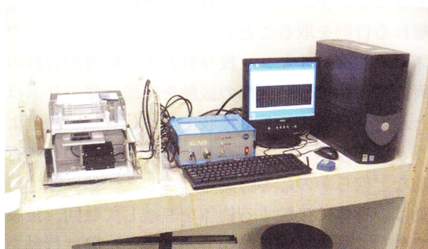
図1：接触刺激応答計測装置（LRM）の全体像。システムは、刺激装置本体（左端）、駆動装置コントローラー兼アナログ/デジタル（A/D）コンバーター（中央）およびコンピュータ（右）から構成される。
